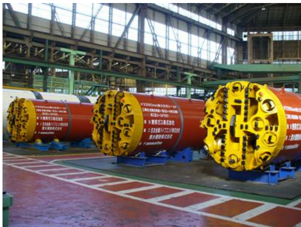
写真 現在工事中の幹線工事区間に使用するシールドマシン
