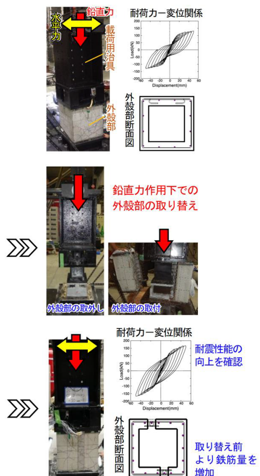
図3 鉛直荷重支持下での外殻部取替実験と耐震性能向上の把握
