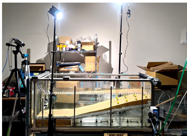
図1 海底地すべり模型実験装置写真
