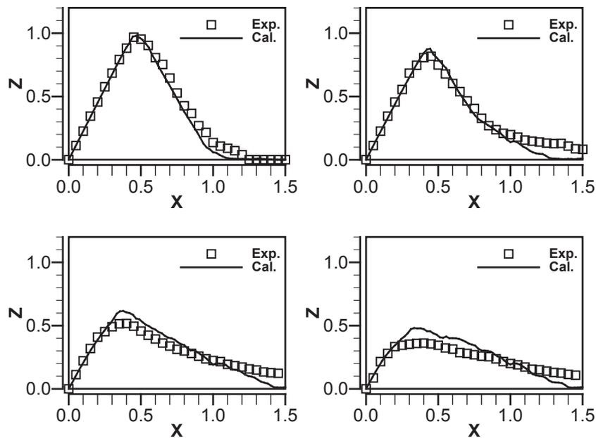
図3 堤体形状の時間変化 (左上:  $t = 2.8$  s, 右上:  $t = 5.7$  s, 左下:  $t = 14.1$  s, 右下:  $t = 28.3$  s)
