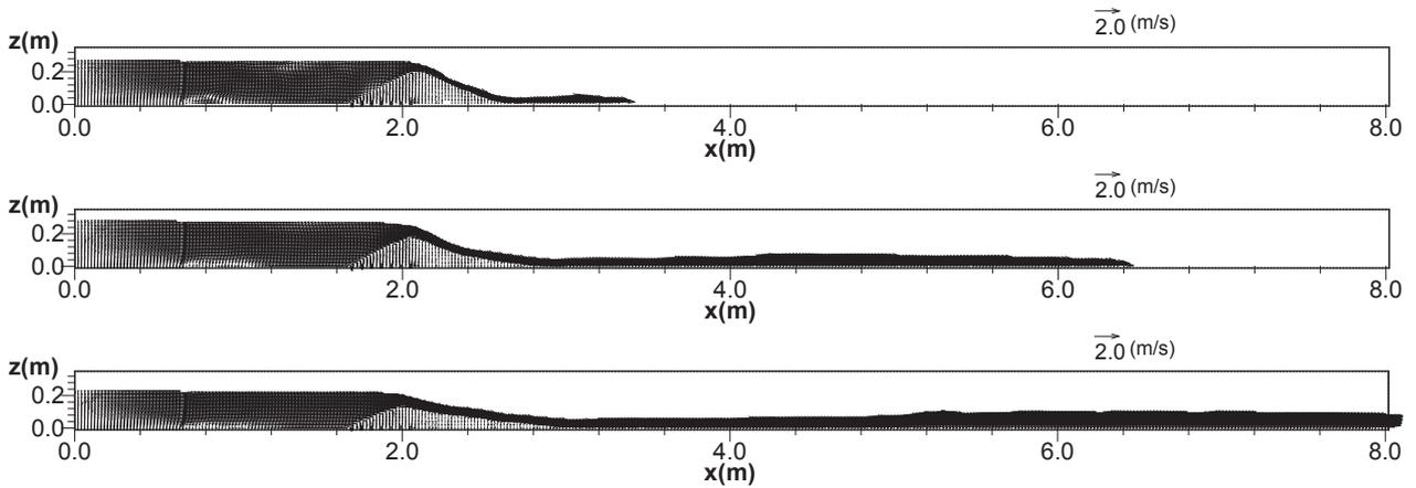
図2 流況の時間変化 (上:  $t = 2.8$  s, 中:  $t = 5.7$  s, 下:  $t = 14.1$  s)
